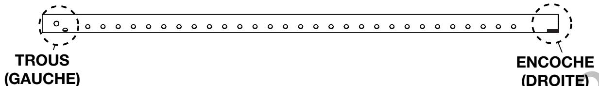
1. Avec la porte de l'appareil ouvert ou enlevé, inserez le côté gauche du tuyau d'air secondaire dans le trou dans **le côté gauche** de l'appareil.
