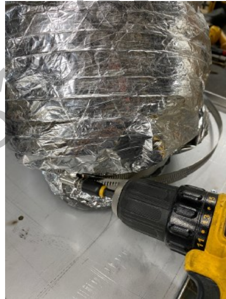
Figure 2.15 - Revêtement externe fixé avec le collier de serrage
