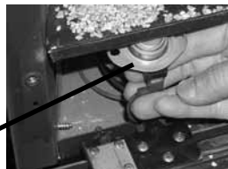
Enlever les deux boulons qui retiennent le boîtier d'interrupteur, puis retirer le thermodisque de son support.
